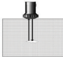
Hình 1.1 Nguyên lý làm việc cơ bản để phát hiện bằng sóng siêu âm
